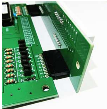
付属の L 型ピンヘッダとソケットで接続する
