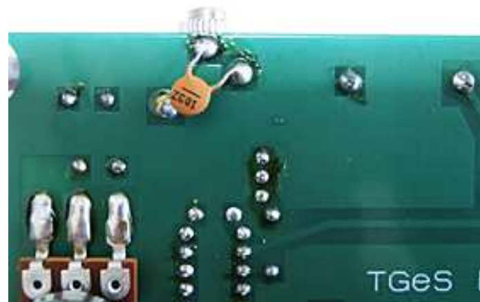
キー出力ジャック J3 にセラミックコンデンサを接続
